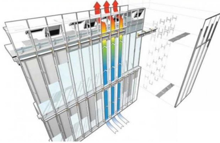
شكل (7) الطاقة الشمسية السلبية ، باستخدام واجهة الجلد المزدوج 1
